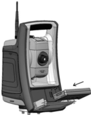
3. Fermez la porte du logement batterie, vérifiez que les deux boutons de dégagement batterie se cliquent en place.
