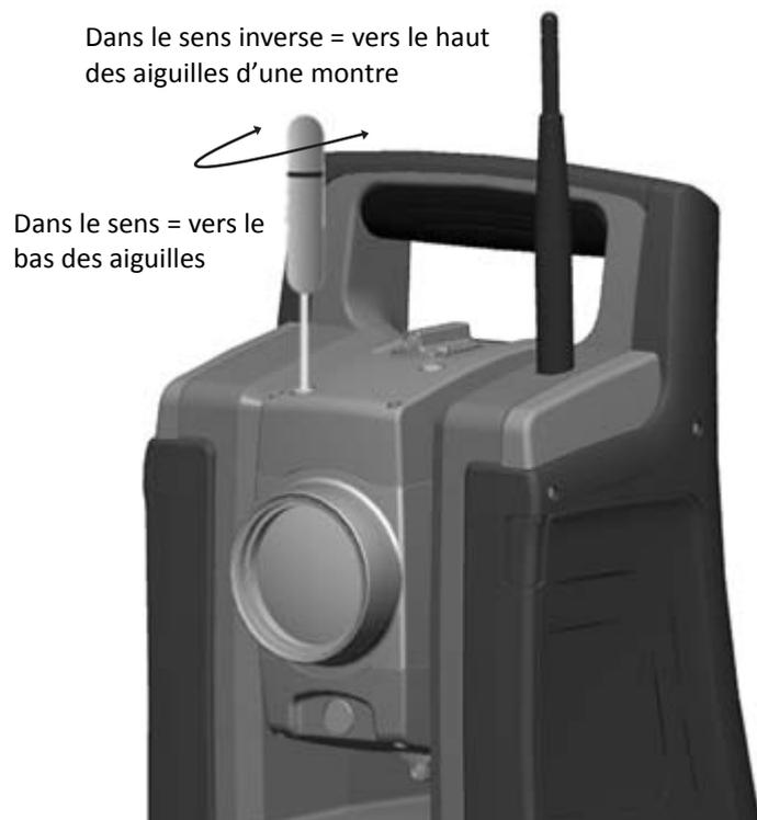
3. Pour corriger la position horizontale du point laser, insérez la clé allen dans le port de réglage horizontal et tournez-la comme illustré dans :
