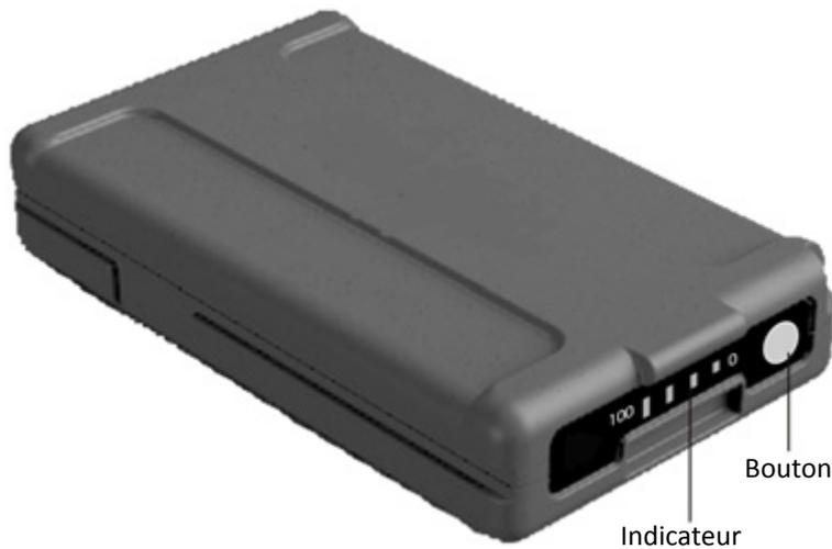
Lorsque vous appuyez sur le bouton, quatre LEDs sur la batterie indique le niveau d'alimentation. Chaque LED correspond à un niveau d'alimentation de 25 % afin que lorsque le niveau d'alimentation se trouve à 100 %, tous les quatre LEDs sont allumées. Si la batterie est complètement épuisée, toutes les LEDs sont éteintes.
