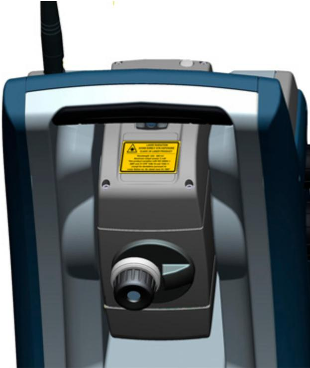
Etiquette d'avertissement de l'unité de mesure de distance et le pointeur laser:
